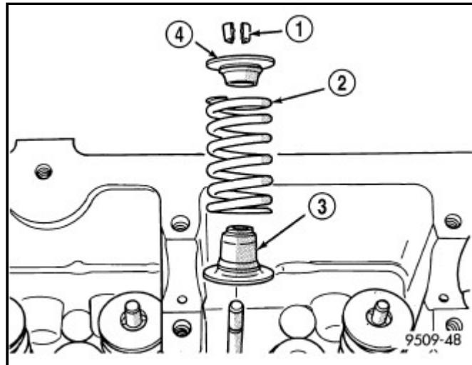
3. 将阀门保持器放置在固定器里。 使用公制阀门保持器工具，如Snap-on® GA317(或同类产品)安装器(2)及拆卸器(1)作为把手，向下推动，安装阀门保持器。
